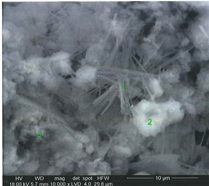
Struktura zestalonego spoiwa – obraz SEM
